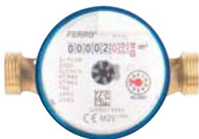
**Contor de apă monojet pentru apă rece, cu protecție împotriva câmpurilor magnetice externe și cu poziție orizontală sau verticală de montare**
